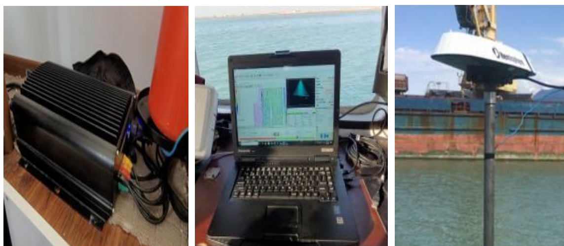
شکل ۴: (الف) سامانه تعیین جهت، (ب) سامانه ناوبری و جمع‌آوری داده‌های عمق‌یابی، (ج) سامانه عمق‌یاب چندپرتوی DRX
