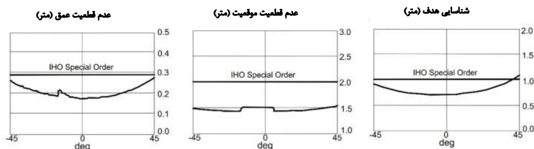
شکل ۷: عدم قطعیت سامانه چندپرتوی در عملیات هیدروگرافی بندر بوشهر
